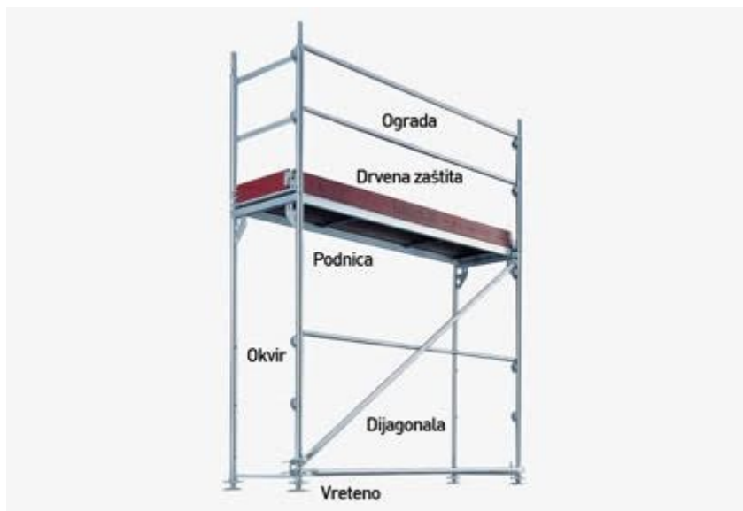
Slika 1- Nacrt čelične skele
